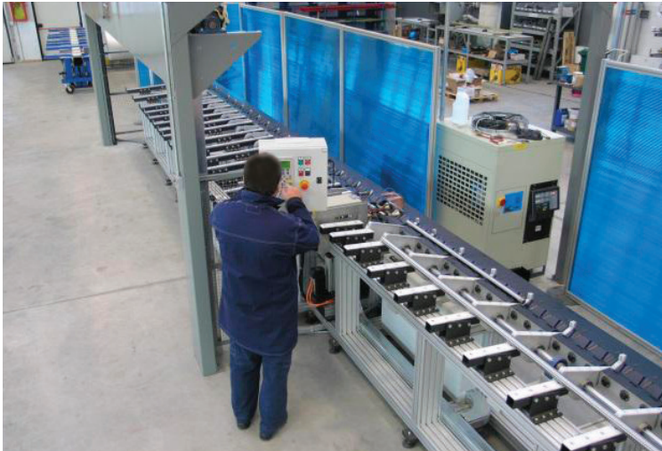
Rinvenimento ad induzione terminali / Journal ends induction annealing
